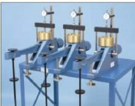
*prova di compressione a espansione laterale impedita:*
