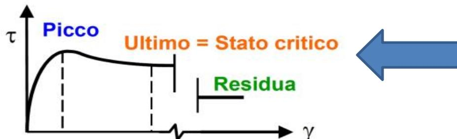
**Condizione di stato critico: Il terreno si deforma a volume costante senza variazione di resistenza.**
